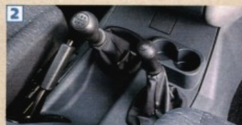
▲ Трансмиссия механическая, 5-ступенчатая. Управление раздаткой по старинке — рычагом
