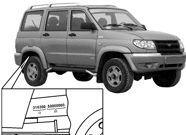
Рис. 1.3. Расположение идентификационного номера шасси
